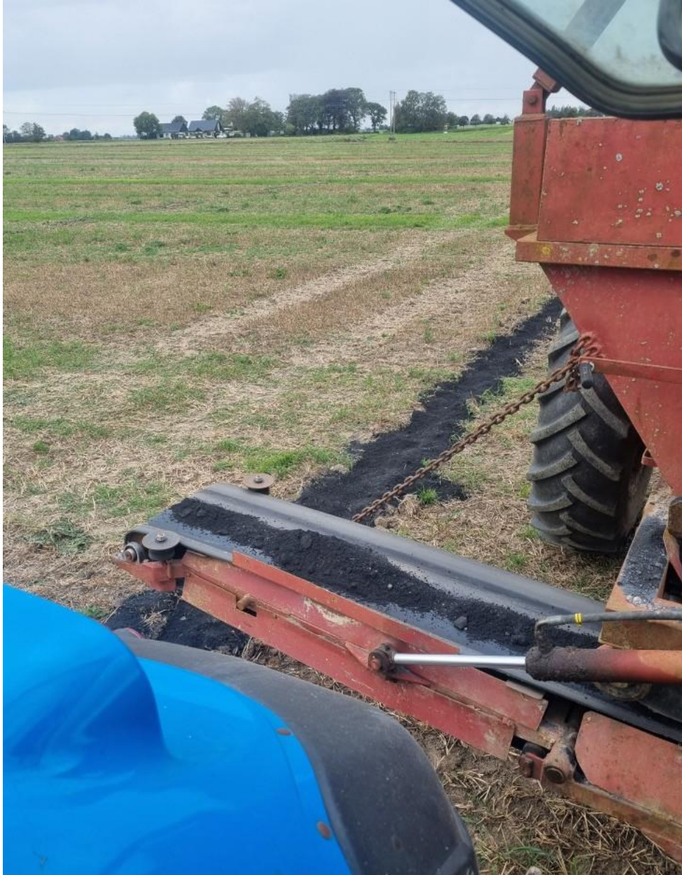
Kalkspridning innan kedjegrävning – Bredalsvagn
