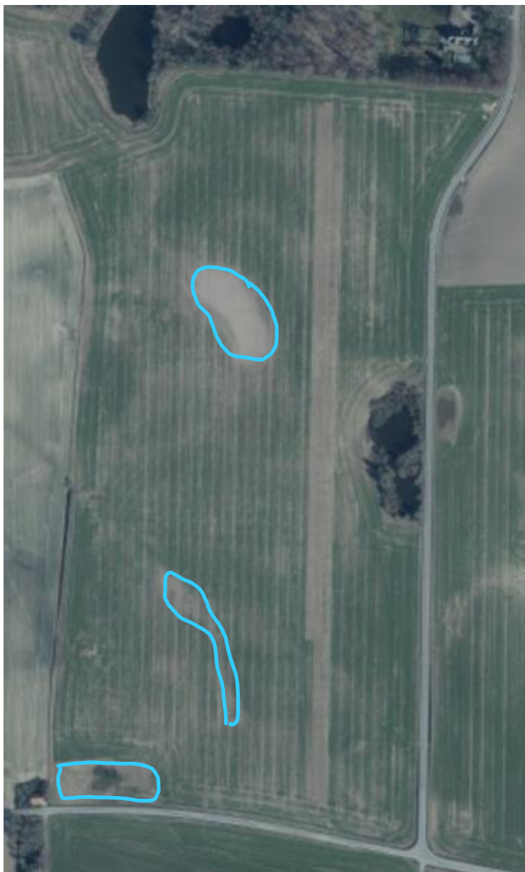
Problemområden med periodvis stående vatten
