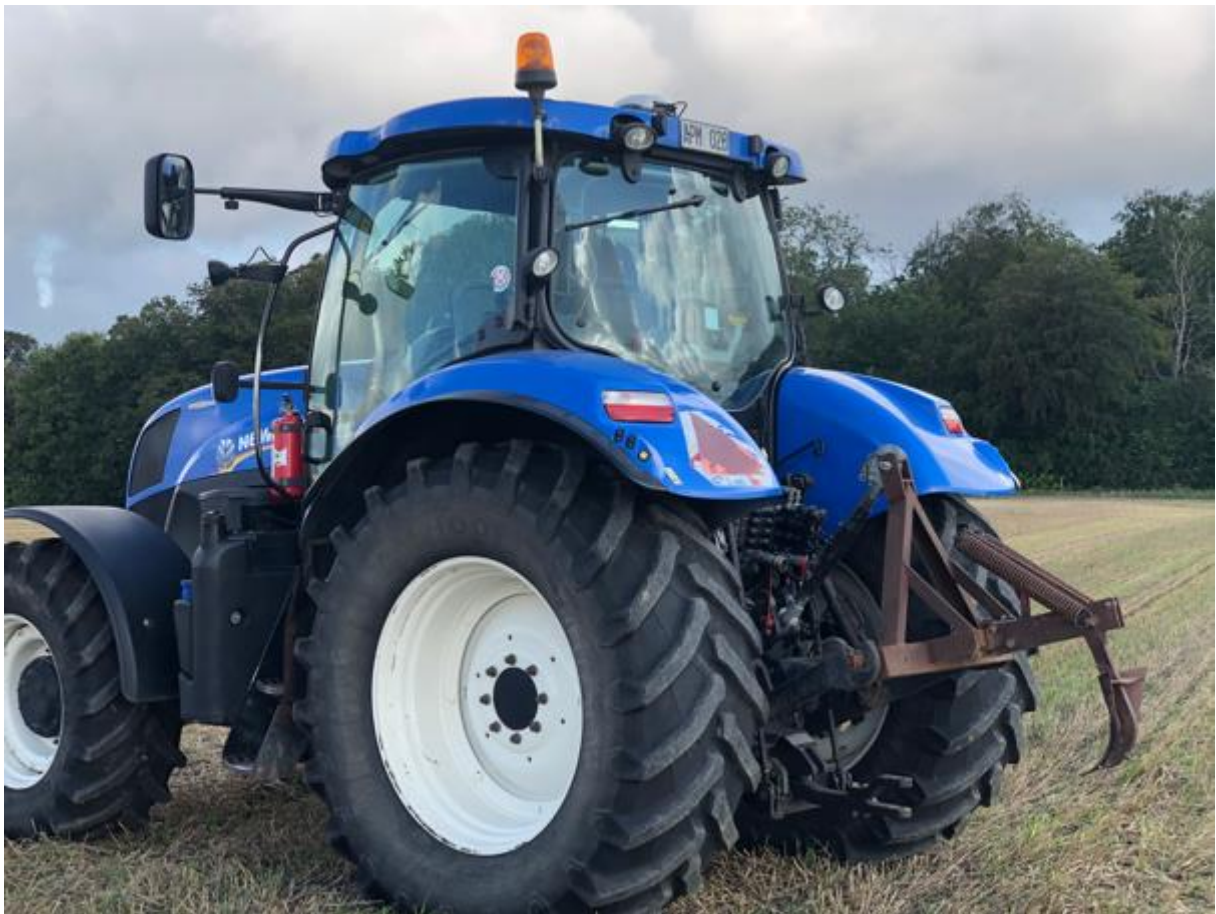
Traktor med rits för att markera grävlinjer för kedjegrävaren
